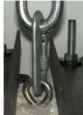
Fixation dans un bloc de granit. Exemple de traction axiale sur broche FIXE
