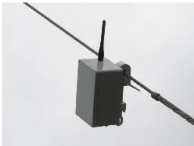
Figure 8. Un Indicateur d'impact aviaire fixé à une ligne électrique. Ces équipements sont relativement petits et peuvent être attachés à un simple câble électrique pour enregistrer automatiquement les collisions des oiseaux grâce à la vibration du câble.
