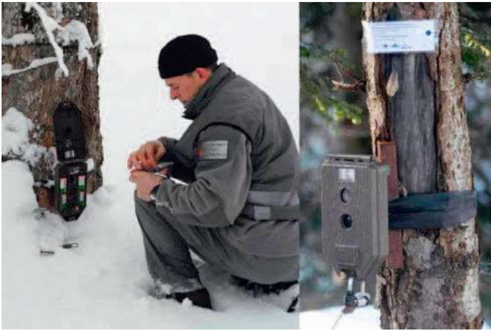
Installation d'un piège photographique dans le Doubs. Les appareils sont posés à la hauteur du garrot de l'animal, de part et d'autre d'un passage connu ou supposé.
