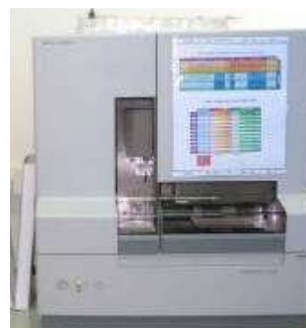
Séquenceur automatique à 16 capillaires (ABI 3130x)
